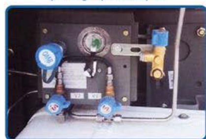
Instalación Terminada para carga rápida NGV2 y NZ
